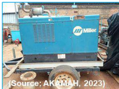
Photo 2: Poste à souder à gazole
